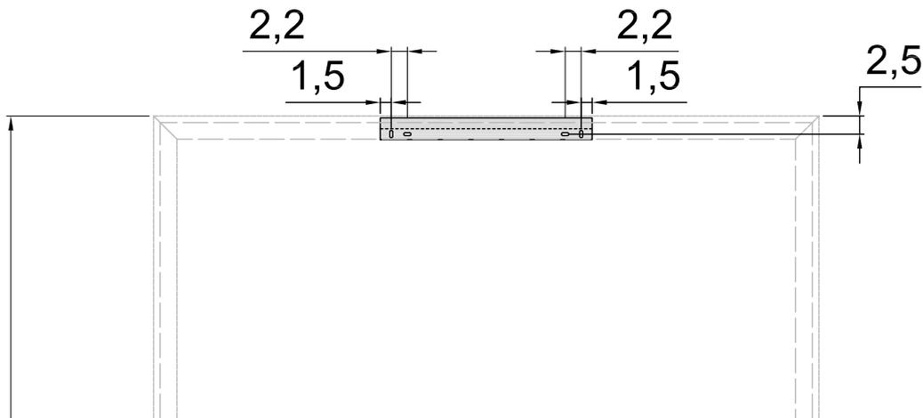
N.B. Dettaglio della squadretta di fissaggio
