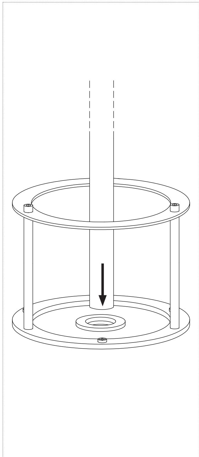
**IT\_3** Collegare il tubo rigido del lavabo allo scarico a pavimento.
