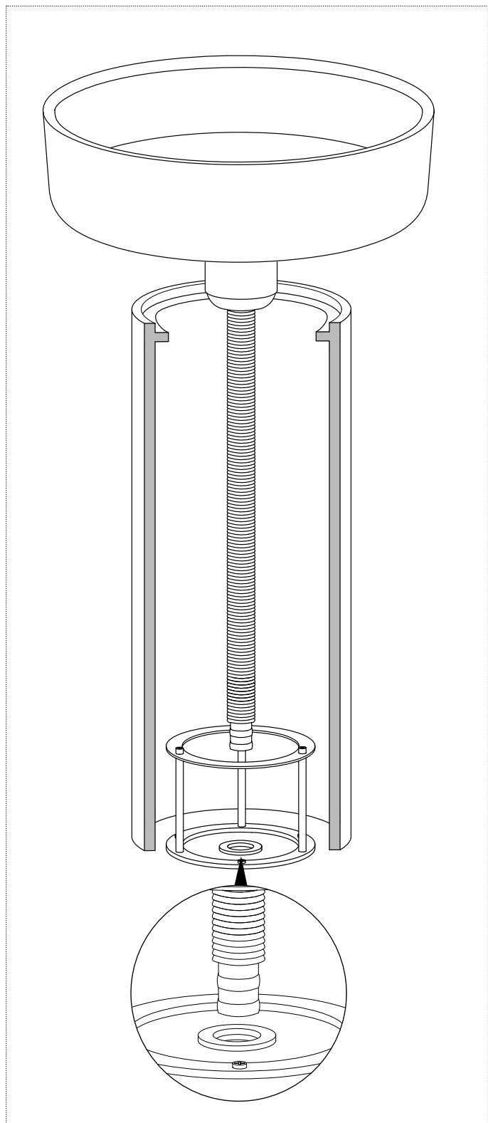
**IT\_2** Avvitare il tubo flessibile al sifone, appoggiare il bacino alla colonna, vincolare i componenti avvitando la piletta.
