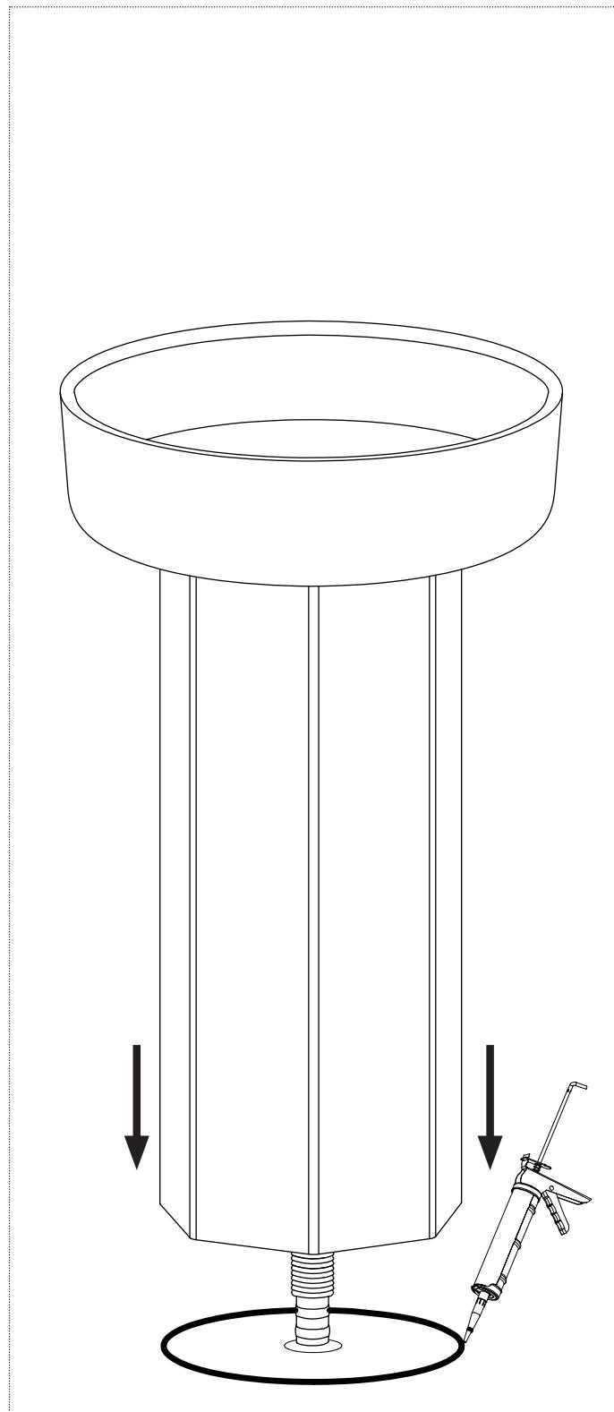
**IT\_4** Sollevare l'articolo e fissare il tutto con silicone o collante a seconda del tipo di pavimento.
