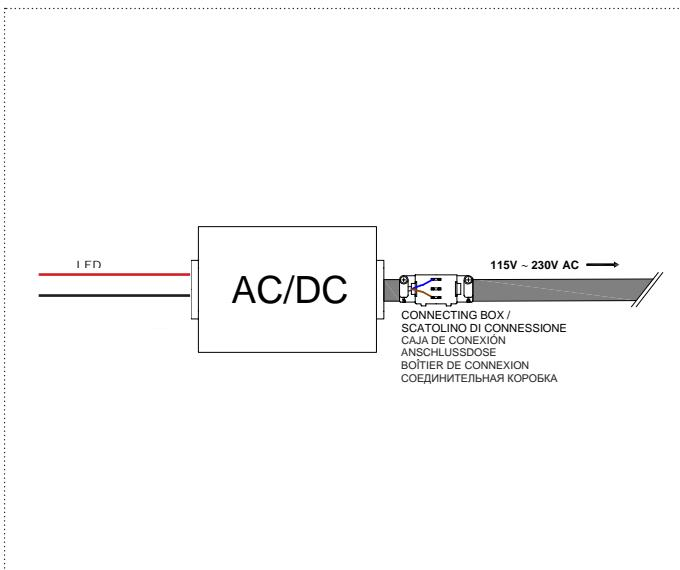
**IT\_4** Effettuare il collegamento elettrico fra la rete ed il trasformatore **AC/DC**, utilizzando lo scatolino di connessione in dotazione così come indicato.
