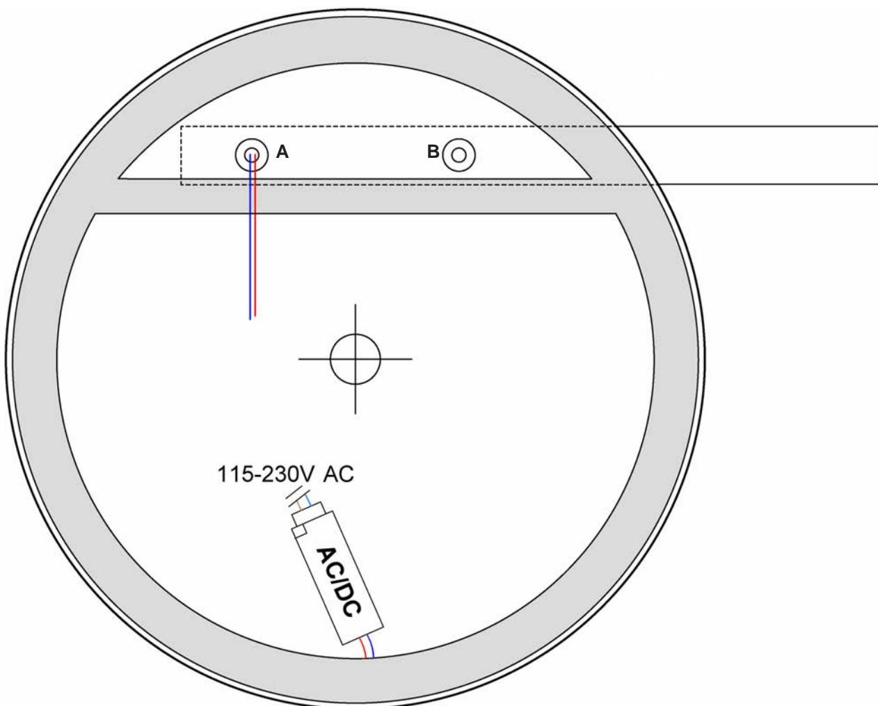
**IT\_N.B.:** Si consiglia di prevedere l'uscita del punto d'illuminazione in corrispondenza del centro dello specchio. Fissare la lampada allo specchio nelle apposite forature **A** e **B**.
