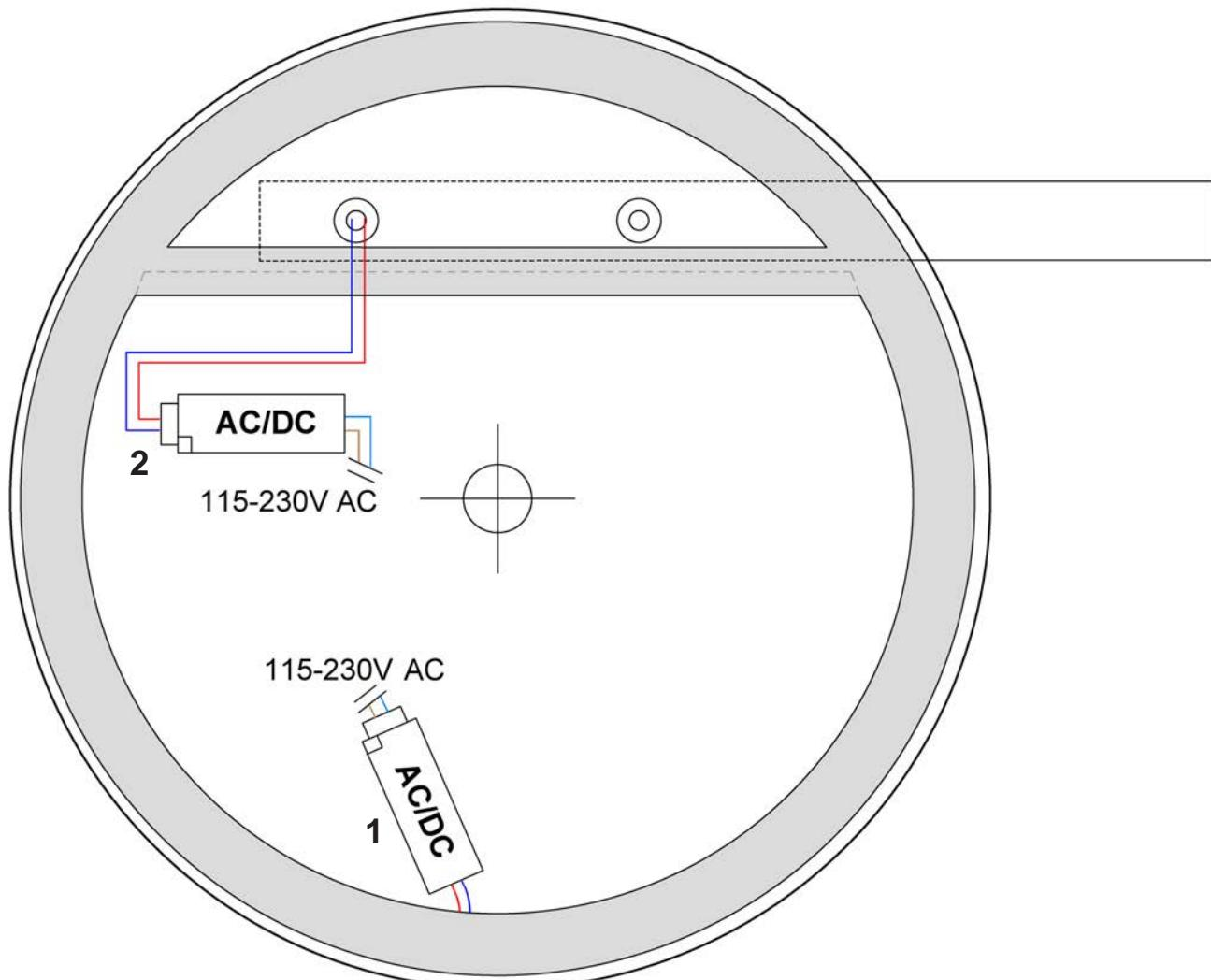
**IT\_2** Collegare la lampada all'impianto elettrico secondo questo schema. Fissare il trasformatore 2 sul retro dello specchio utilizzando il biadesivo in dotazione.
