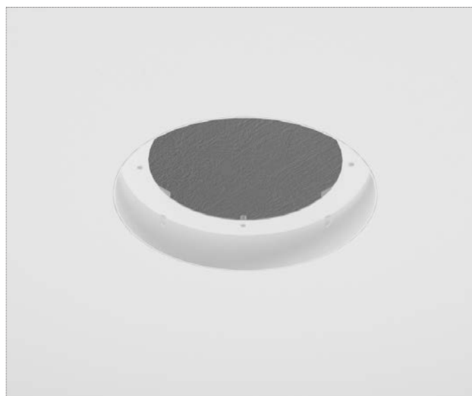
7_ Rifinire il controsoffitto con una stuccatura/rasatura per rendere la superficie omogenea, facendo attenzione a non rovinare la struttura del soffione
